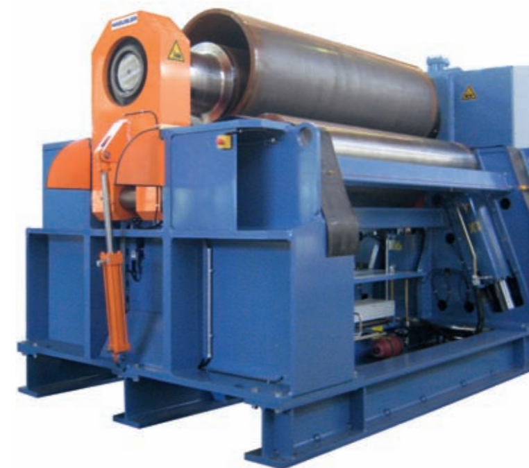
4-Walzen-Blechbiegemaschine Typ VRM-hy 3 000-610 Blechbreite 3 000 mm, Wandstärke 80 mm
